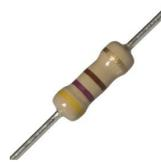
c'est le dipôle le plus simple pour lequel tension et intensité du courant électrique sont proportionnelles (en régime continu ou variable). La loi courant-tension s'écrit ainsi en convention récepteur :
